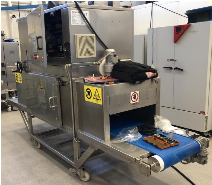
Figur 1 Stalam RF-testmaskin (7 kWh) leid for testforsøk i mindre skala.
